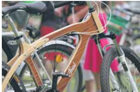
Wyjątkowy eko rower. Rama wykonana całkowicie ze sklejk drewnianej
